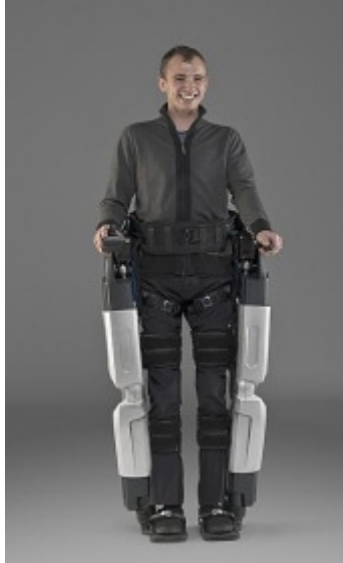
Figura 2.3: Rex Rehab, exoesqueleto que permite que cadeirantes se levantem, andem e subam escadas. (Rex Bionics website)
